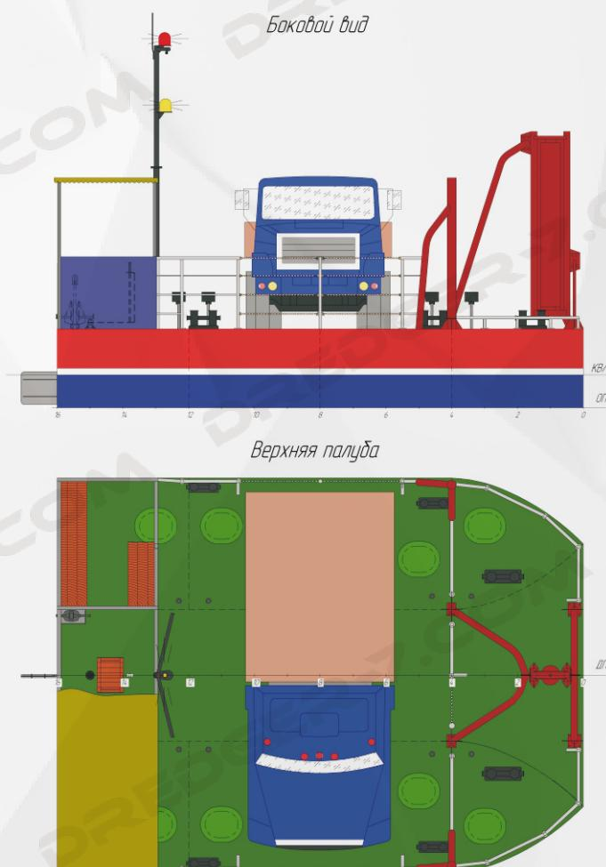
Тип судна - несамоходный, стальной, однопалубный двухкорпусный ponton без надстройки, предназначенный для перевозки не более 12 человек под навесом и одного автомобиля (массой до 5т).
