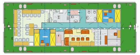
Тип судна – несамоходное, стальное, плавучее сооружение с корпусом понтонного типа, с расположенной на главной палубе двухъярусной надстройкой, дизель-генераторным и насосным отделениями в корпусе судна.
