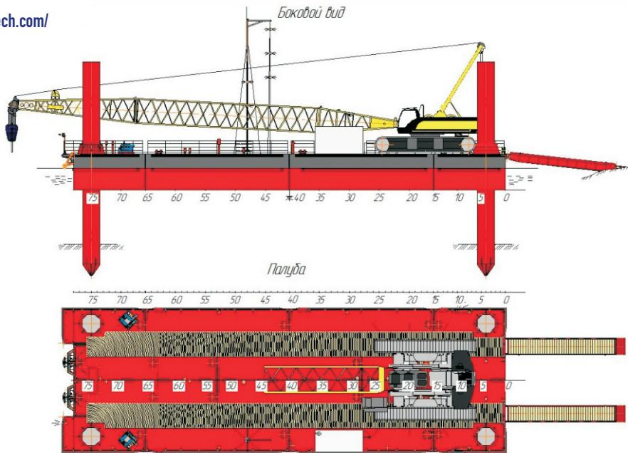
Назначение – временная несамоходная плавучая технологическая площадка, под установку крана грузоподъемностью 150т, для выполнения работ по забивке свай, при помощи вибропогружателя и выполнения грузовых операций.
