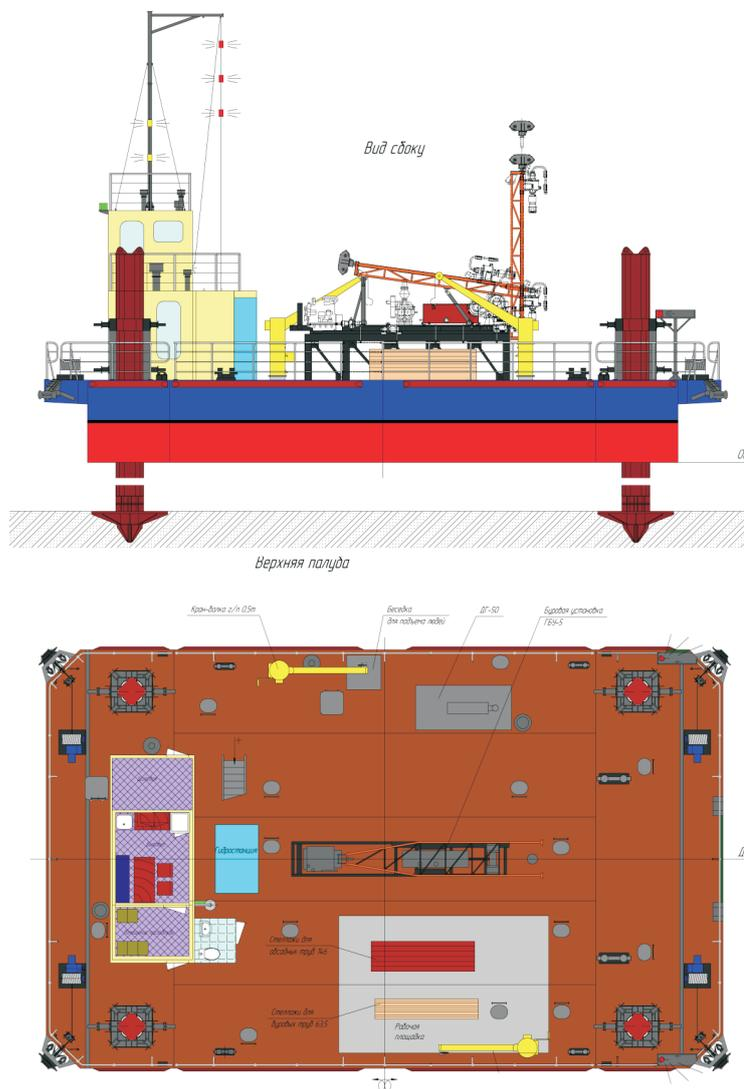
Несамостоятельная самоподъемная многофункциональная модульная плавучая площадка с установленным на ней буровым станком и комплектом оборудования, предназначена для инженерно-геологических исследований и изысканий грунтов морского и речного дна.
