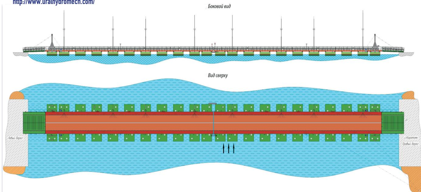
Наплавной мост предназначен для двухстороннего движения в одну полосу легкового автотранспорта, одностороннего регулируемого движения грузовых и грузопассажирских автотранспортных средств, допускаемой массой 32 т и двухстороннего движения пешеходов.
