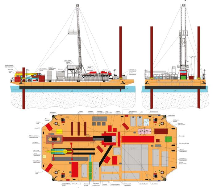
Назначение основания - строительство в безледовый период поисково-разведочных скважин на малых и сверхмалых глубинах. Площадка понтонного типа с буровой установкой МБУ-160 (HRI-700) и технологическим оборудованием устанавливается на 4-х закольных сваях при помощи папильонажных лебедок. На палубе кроме буровой установки и судового оборудования установлены контейнизированные блок-модули для размещения оборудования и персонала.
