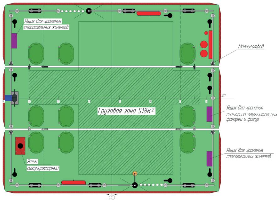
Трехсекционный понтон предназначен для перевозки технологического оборудования и расходных материалов. Класс Регистра – Р mc 1,2.
