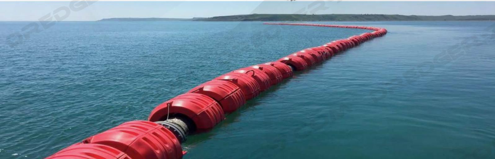
Ду 325 L=9\ 1 штука (речной) плавающий, стальной, на шаровых соединениях, с освещением - 2 светильника, ограждением 1100мм, и трапами, один спасательный круг.
