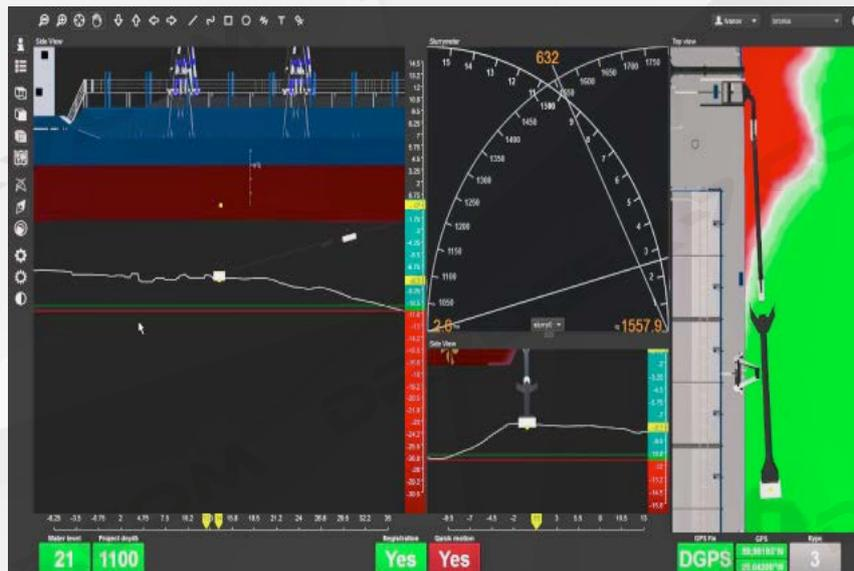
Дистанционный мониторинг работы земснаряда в текущий момент и за весь проект в целом реализуется через облачный сервис FleetControl. Данный сервис консолидирует на сервере данные с любого количества земснарядов, на которых установлены системы мониторинга, визуализирует их, собирает в табличные и графические представления, дает возможность дистанционно загружать свежие гидрографические данные и технические задания для земснарядов. Благодаря ему руководитель сможет:
