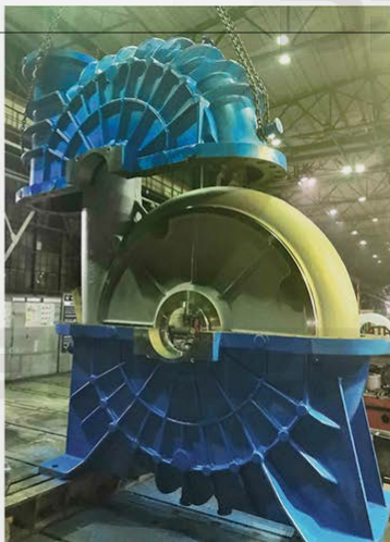
Характеристики модернизированного насоса 2ГрТ 13000/85
