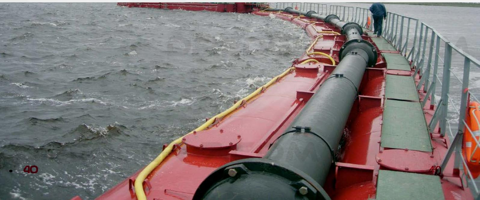
Плав кран г/п 3т лебедки ручные с тросом 14 мм, два спасательных круга, мотор Yamaha 9,9GMH, бак запаса топлива, лавка, трап сходня, леерное ограждение, балластные люки.
