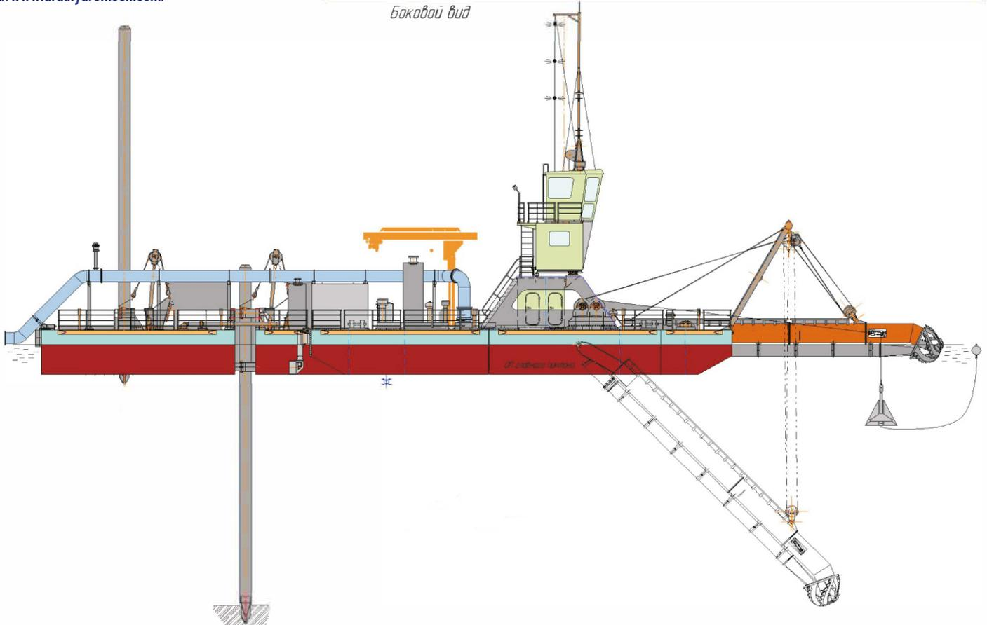
Тип судна – плавучий, самоходный, модульный, сборно-разборный, дизельный с фрезерным рыхлением землесосный снаряд (земснаряд) производительностью по пульпе 4000 м<sup>3</sup>/ч с разборным металлическим корпусом, съемными надстройками и рубкой управления.
