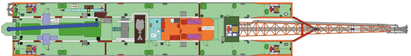
Тип земснаряда – плавучий, несамостоятельный, дизельный, сборно-разборный земснаряд, с гидроразрывом и эжектированием, производительностью по воде 3000 м<sup>3</sup>/ч.
