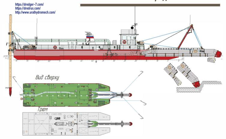
Тип – плавучий, несамоходный, дизельный земснаряд с гидравлическим и фрезерным рыхлением, производительностью по грунту около 500м3/ч.
