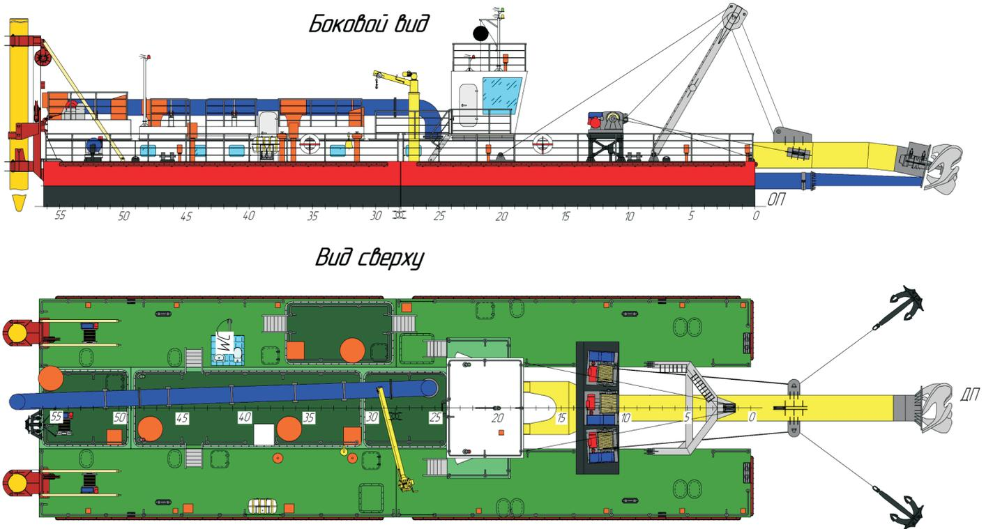
Плавучий, несамоходный, электрический сборно-разборный земснаряд со сменной рамой (для фрезерного и гидрорыхления грунта), производительностью 4000 м<sup>3</sup>/час по пульпе.
